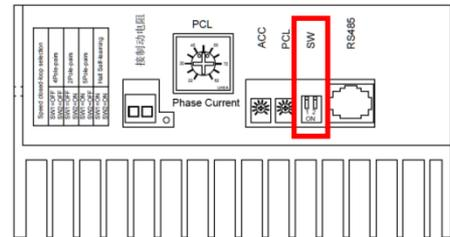
**注意** 调整拨码, 请设定电机极对数对应的 SW 设定, 霍尔自学习时请保证通讯禁能且控制信号无输入, 学习成功后电机将低速运行, 掉电后学习数据丢失。
